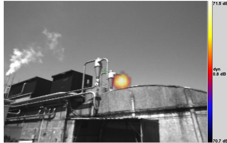
Ruido com origem no transporte de material para o ciclone
