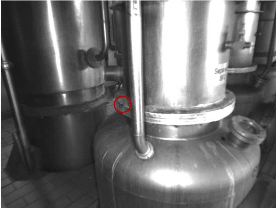
Fuga de vácuo por ponto de corrosão em flange
